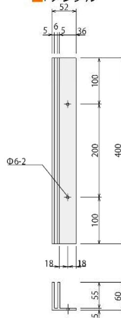
セパレーター本体・固定用Fアングルともに塩ビ製なので、軽量で作業性に優れています。
